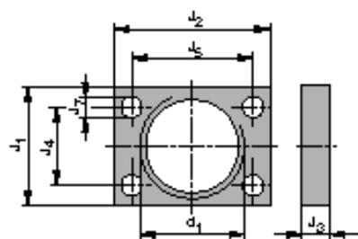
**Abmessungen (mm) – Quadratflansch**
