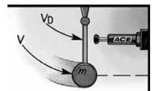
Die effektive Masse (me) kann die tatsächlich in Bewegung befindliche Masse oder eine Ersatzmasse für die Antriebskraft oder Übersetzung + tatsächlicher Masse sein.
