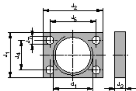
**Abmessungen (mm) – Anschlaghülse**
