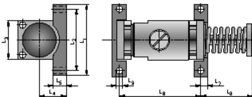
**Abmessungen (mm) – Anschlaghülse**
